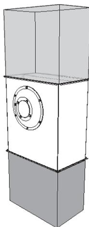
Вентилятор может устанавливаться в любом положении. При подключении воздуховодов обратите внимание на направление воздушного потока, указанное на корпусе изделия.
